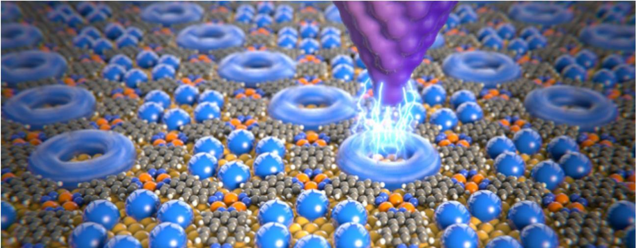
Graphische Animation eines möglichen Datenspeichers auf der atomaren Skala: Ein Datenspeicherelement – bestehend aus nur 6 Xenon-Atomen – wird durch einen Spannungspuls verflüssigt. (Illustration: Departement Physik, Universität Basel)
