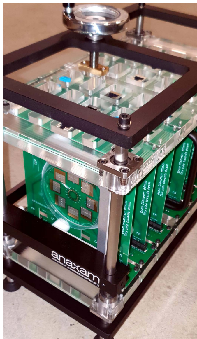
Der mit Halbleiterchips bestückte Probenhalter für die geplanten Bestrahlungsexperimente wurde im Nano-Argovia-Projekt CRONOS entwickelt. (Bild: FHNW Windisch)
