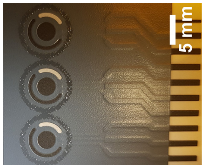
Hochsensitiver elektrochemischer Sensor, welcher im Projekt «PEPS» entwickelt wird (Bild: CSEM).
