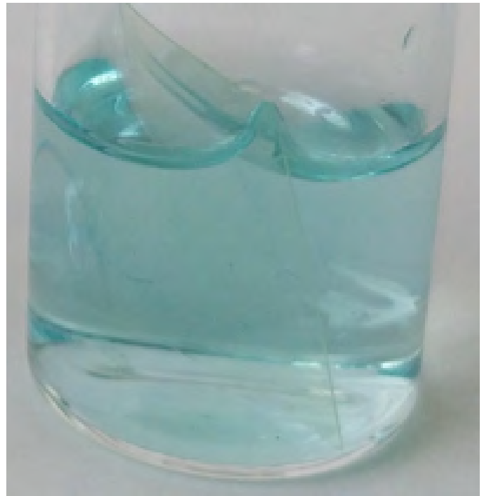
Die blaue Farbe entsteht durch die Aktivität eines auf der Oberfläche verankerten Modellenzym (Bild: INKA, FHNW).
