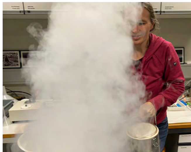
Mit Flüssigstickstoff wird das Kryo-EM gekühlt, damit die Proben auch bei der Analyse tiefgefroren bleiben und so winzige Strukturen erhalten bleiben.
