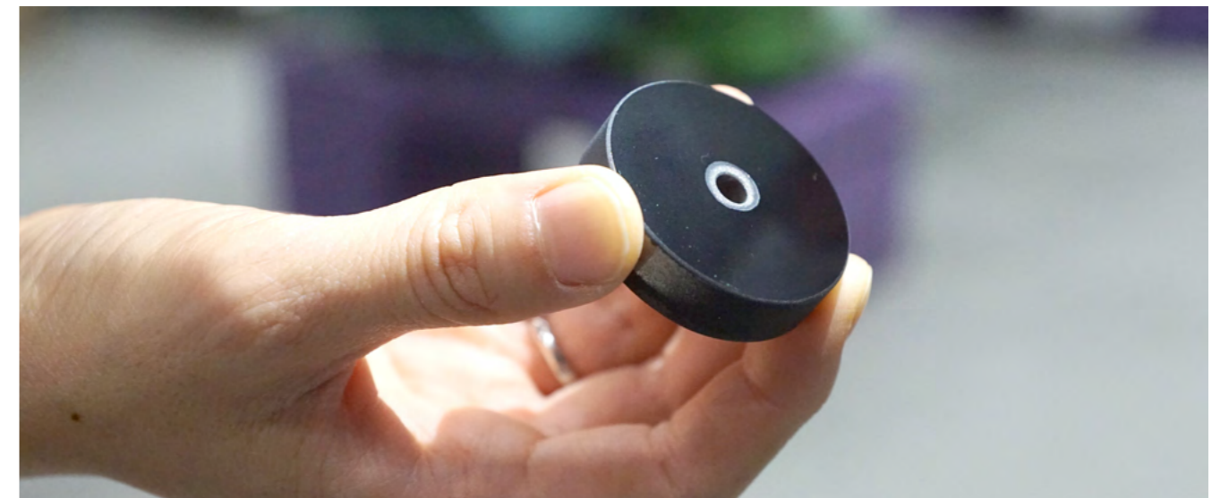
Die Proben wurden mithilfe der Plasmaspray-Methode mit einer Keramiksicht versehen, die dann genauestens untersucht und nachbehandelt wird.
