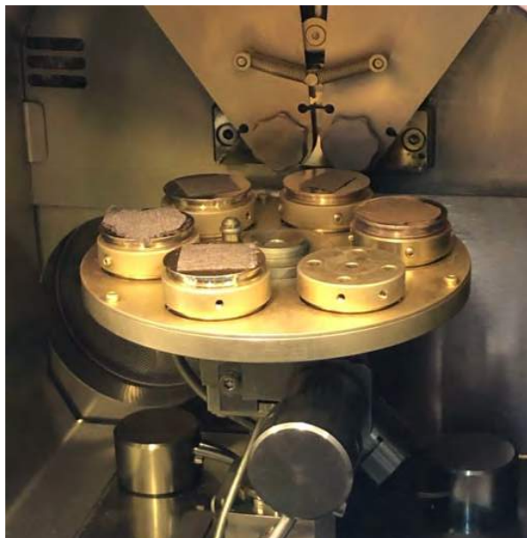
Abb. 8. Mit Goldschicht überzogene Proben
