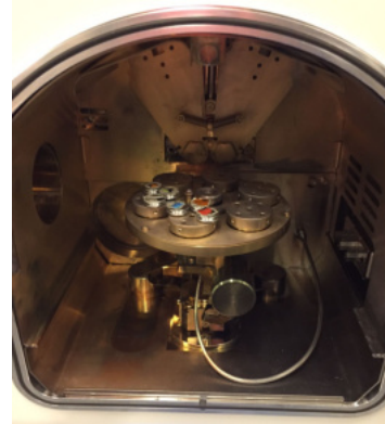
Abb. 15: Proben in der Kathodenzerstäubungsanlage
