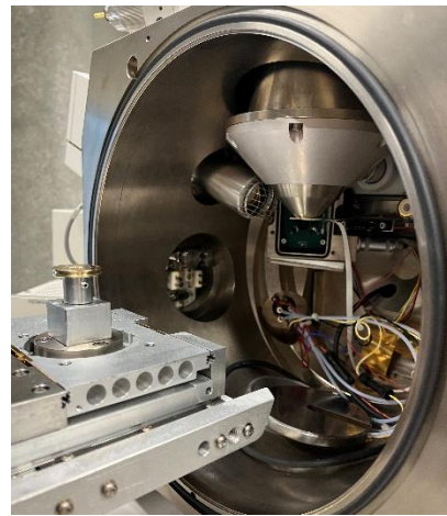
Abb. 5 Innenraum des Rasterelektronenmikroskops, mit Detektor und Proben­tisch
